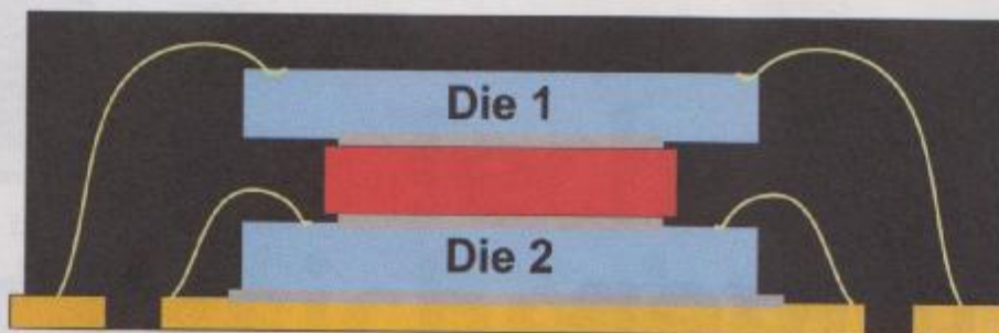
Abbildung 3: Zwei übereinandergestapelte Chips in einem gemeinsamen Gehäuse
